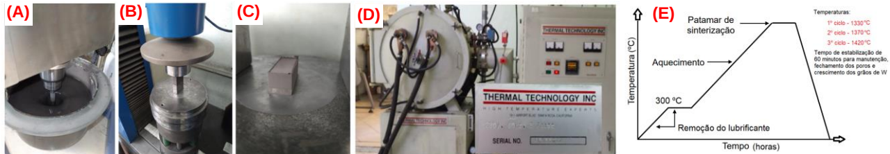
Figura 2 - (A) Agitador convencional sem bolas de metal duro com capacidade de 3kg de misturas; (B) compactação dos corpos de provas na prensa EMIC; (C) Amostra de compactado a verde para o processo MP-SFL; (D) Forno de sinterização a vácuo da empresa Brats (Cajamar-SP); e (E) Ciclo térmico do processo clássico de sinterização.
