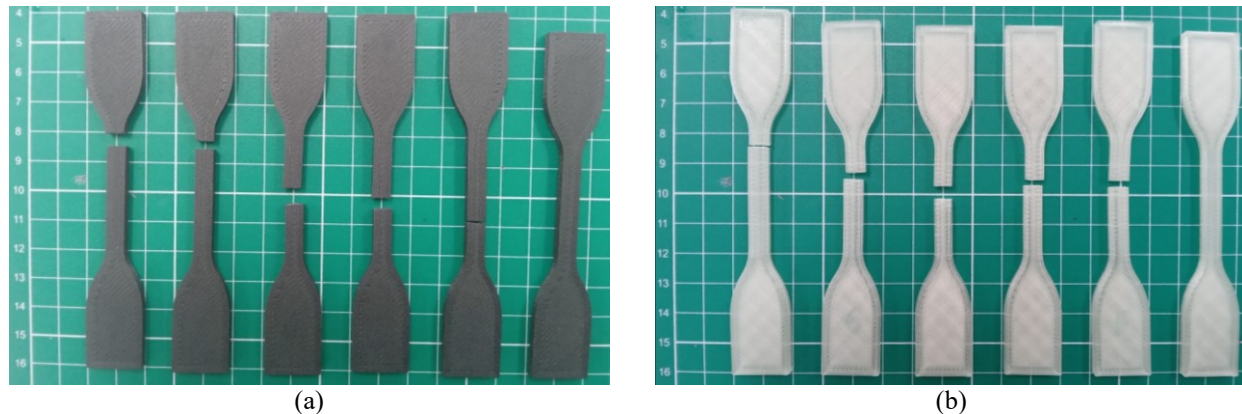
Figura 4. Aspecto dos corpos de prova após realização do ensaio de tração no PLA (a) com e (b) sem grafeno.
