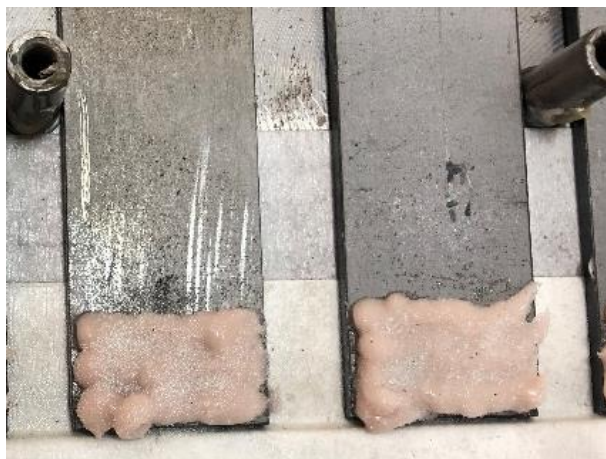
Figura 3. Fotografia do dispositivo e de tiras a serem unidas, momentos antes da colagem.
