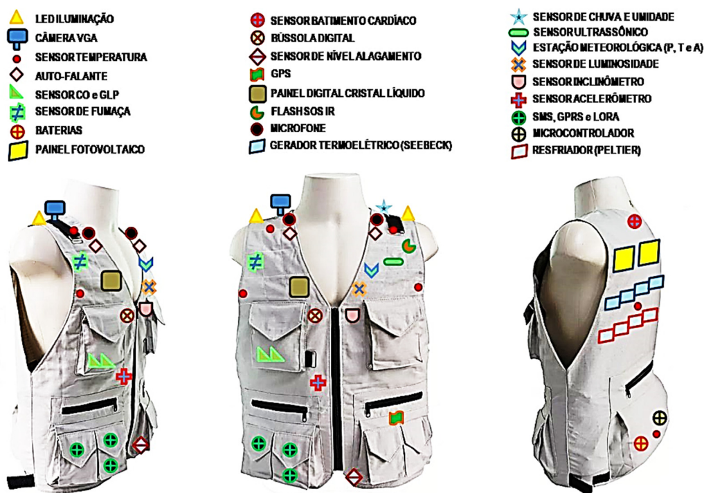
Figura 2. Mapeamento dos sensores distribuídos no dispositivo vestível (colete) para atividades operacionais.
