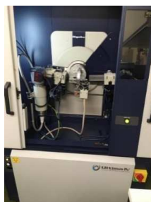
Figura 2 – (a) Difratorômetro marca RIGAKU, modelo Ultima IV, (b) Medidor óptico ATOS Core 80.
