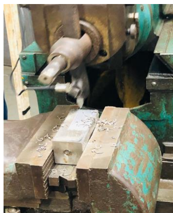
Figura 4. Corpo de Prova fixado na morsa da Plaina
