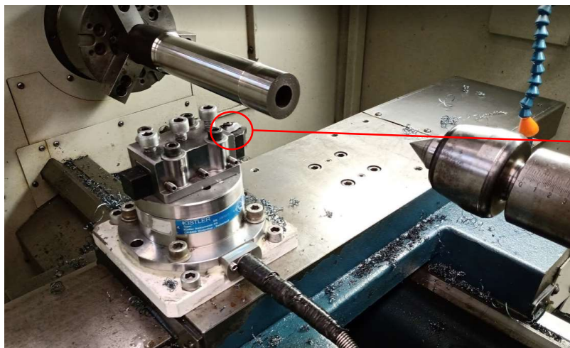
a) Montagem do dinamômetro no torno CNC
