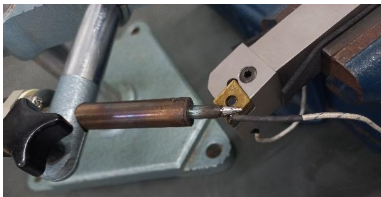
Figura 4. Posicionamento do ferro de solda
