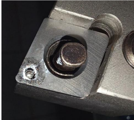
Figura 2. Termopar utilizado para medir a temperatura na base da pastilha de corte
