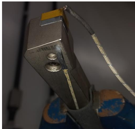
Figura 3. Posicionamento dos termopares na ferramenta
