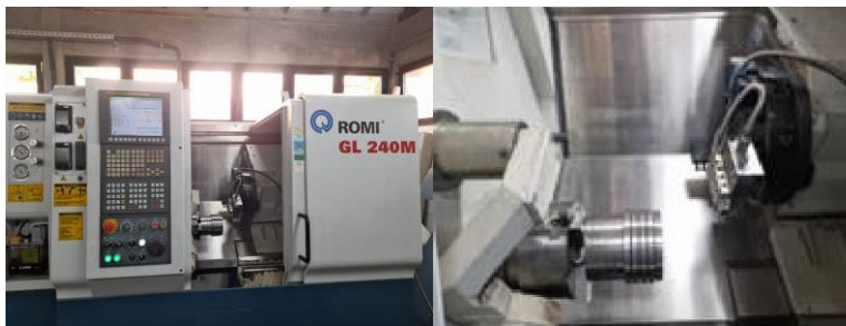
Figura 1. Torno CNC Romi GL 240M (esquerda) e, set up experimental (direita) (Autoria própria).
