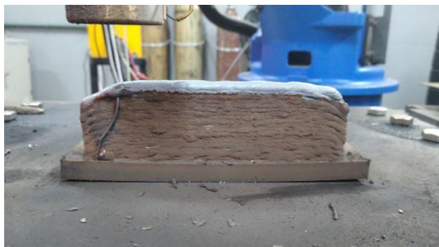
Figura 9. Configuração 2: Temperatura de interpasse 150°C sem alimentação de arame frio - 130 mm
