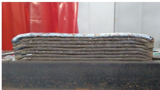
Figura 8. Configuração 5: Temperatura de interpasse 150°C com alimentação de arame frio - 180 mm
