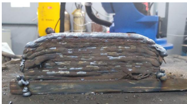
Figura 10. Configuração 5: Temperatura de interpasse 150°C com alimentação de arame frio - 130 mm
