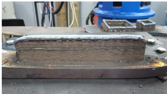
Figura 7. Configuração 2: Temperatura de interpasse 150°C sem alimentação de arame frio - 180 mm
