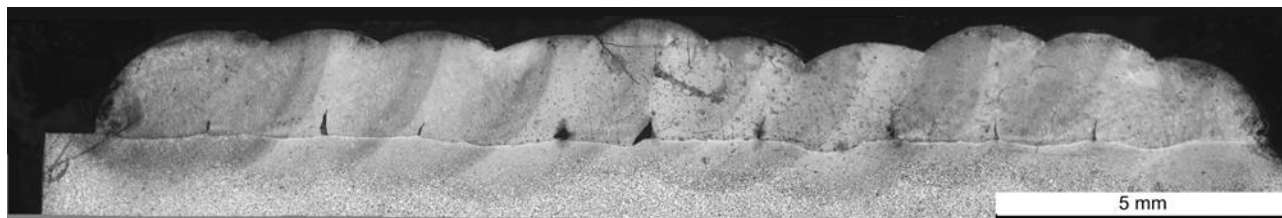
Figura 6. Macrografia do revestimento (Os autores, 2022)
