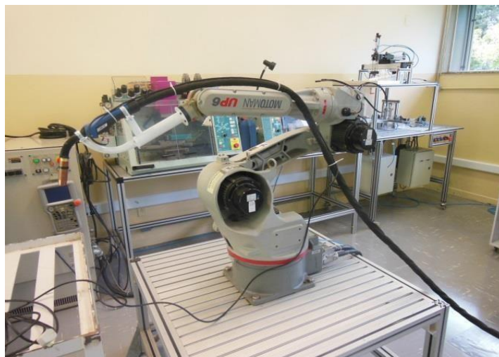
Figura 2. Sistema de deslocamento da tocha: adaptação em braço robótico;
