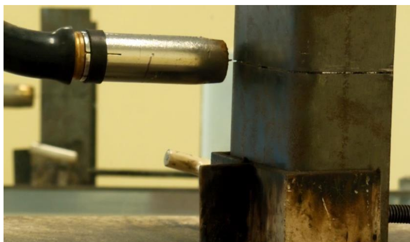
Figura 3. Sistema de deslocamento da tocha: fixação da junta e posicionamento da tocha de soldagem.
