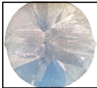
Figura 3. Macroestrutura da liga trabalhada. Fonte: Autoria própria, 2022
