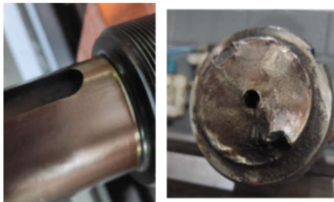
Figura 1. Falha do eixo excêntrico do Bead Hammer
