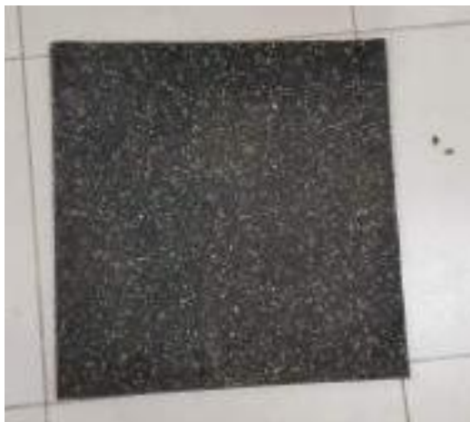
Figura 2 – Amostra de material granulado de pneus reciclados aglomerado com poliuretano de espessura 16mm
