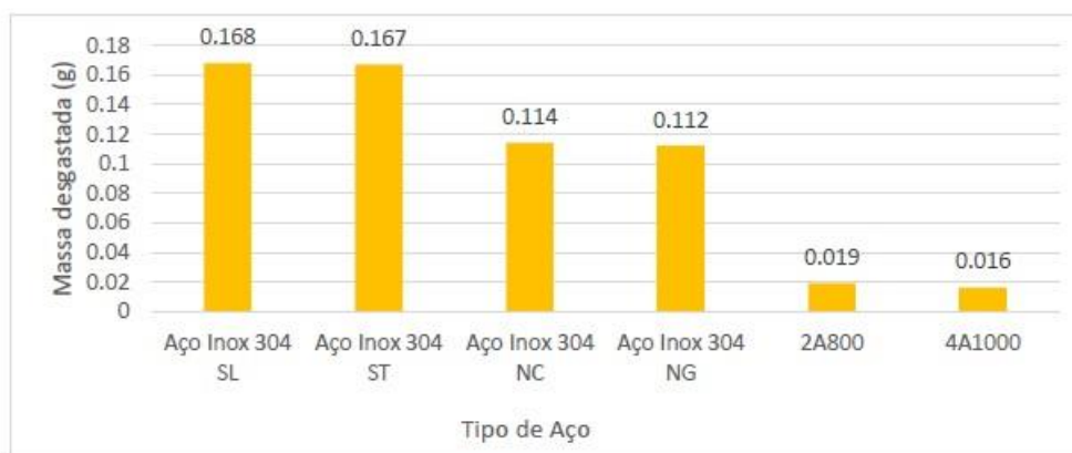
Gráfico 2 – Comparação da massa desgastada sobre a carga de 192,9 kg.
