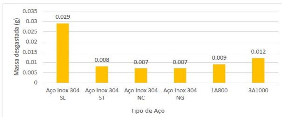
Gráfico 2 – Comparação da massa desgastada sobre a carga de 192,9 kg.
