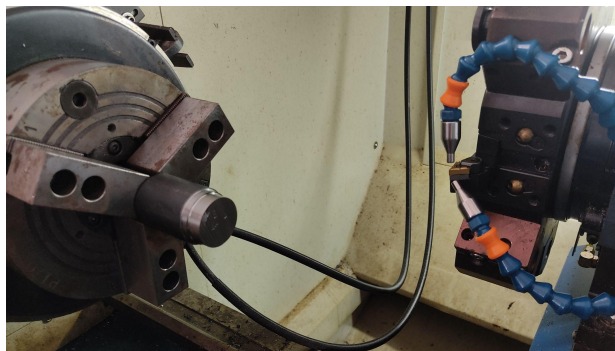
Figura 1. Estratégia MQL 1 (Bico direcionado para superfície de saída e de folga da ferramenta).
