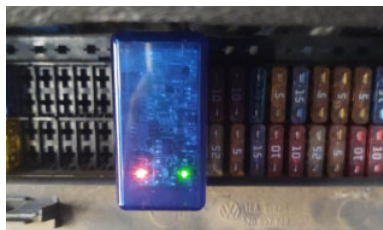
Figura 3: Scanner ELM327 conectado ao carro
