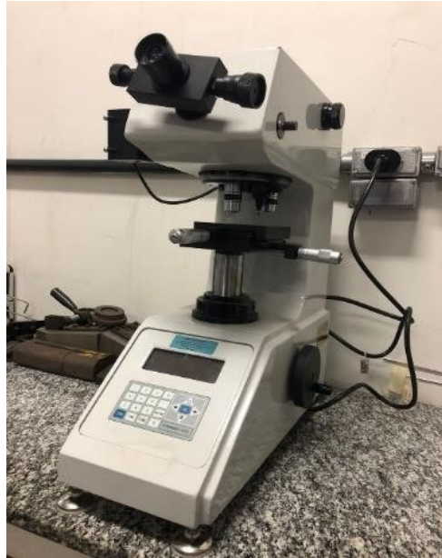
Figura 2. Microdurômetro modelo HV-1000B. Fonte: Autor, 2022.
