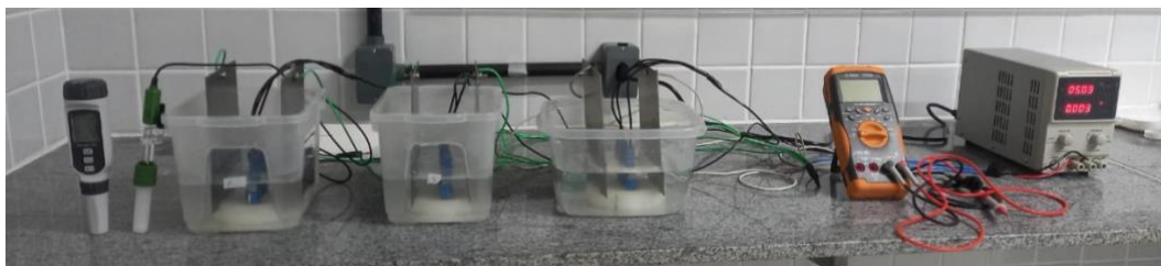
Figura 1. Sistema usado no processo de proteção catódica.
