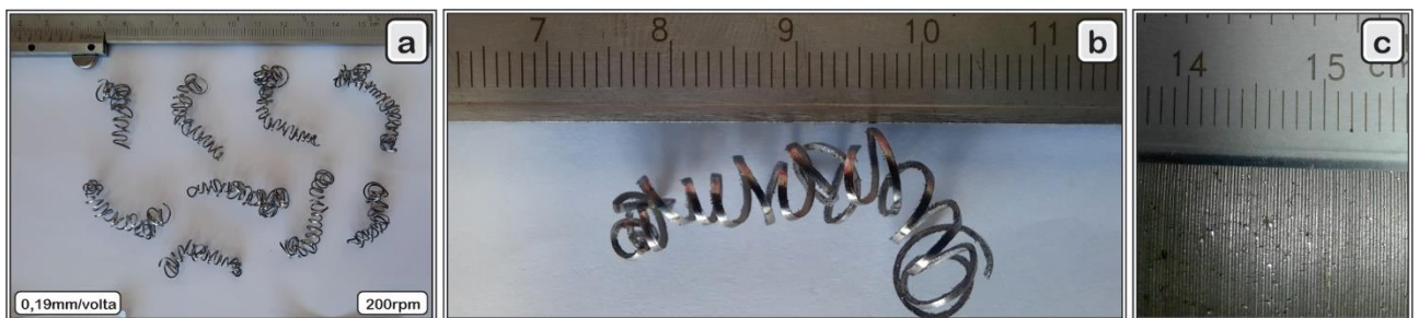
Figura 7. Avanço de 0,19mm/volta e 200rpm: (a) forma do cavaco; (b) ampliação da forma do cavaco; (c) acabamento superficial.
