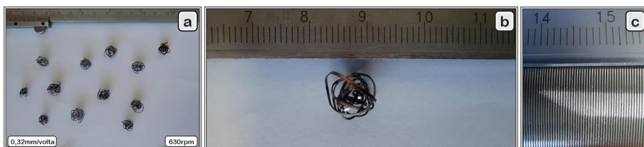
Figura 4. Avanço de 0,32mm/volta e 400rpm: (a) forma do cavaco; (b) ampliação da forma do cavaco; (c) acabamento superficial.
