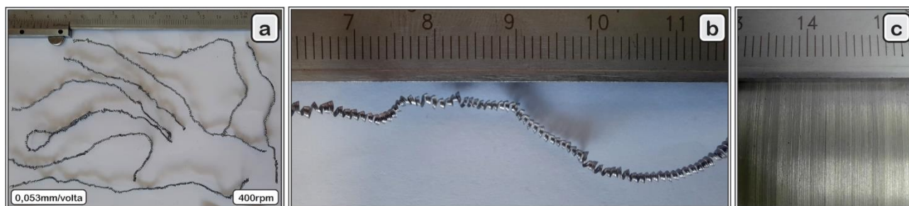
Figura 12. Avanço de 0,053mm/volta e 400rpm: (a) forma do cavaco; (b) ampliação da forma do cavaco; (c) acabamento superficial.
