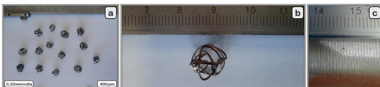
Figura 4. Avanço de 0,32mm/volta e 400rpm: (a) forma do cavaco; (b) ampliação da forma do cavaco; (c) acabamento superficial.
