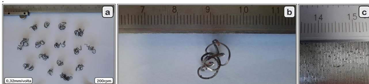
Figura 3. Avanço de 0,32mm/volta e 200rpm: (a) forma do cavaco; (b) ampliação da forma do cavaco; (c) acabamento superficial.
