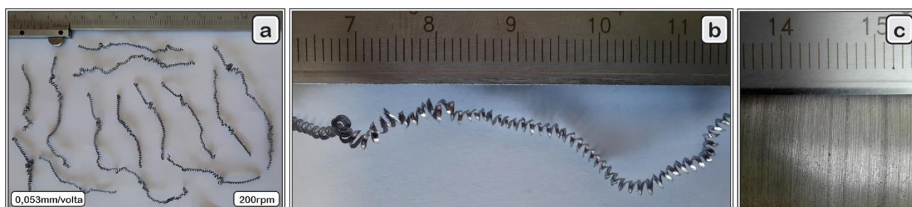
Figura 11. Avanço de 0,053mm/volta e 200rpm: (a) forma do cavaco; (b) ampliação da forma do cavaco; (c) acabamento superficial.
