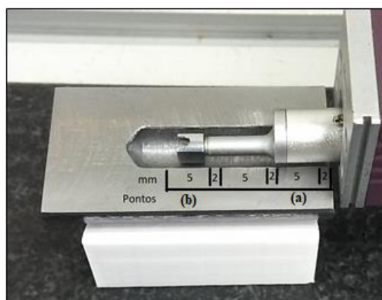
Figura 4 - Medição da rugosidade, a) início do furo e b) final do furo.
