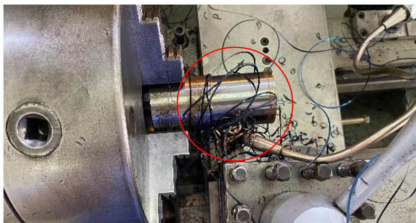
Figura 3. Cavaco emaranhado durante o ensaio com menor avanço ( f_1 = 0,1392 mm/rev).
