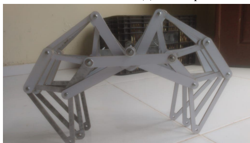
(c) Modelo em escala reduzida completo montado.
