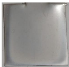
Figura 3. Liga de níquel obtida após eletrodeposição de banho de Watts em substrato de aço SAE1020.
