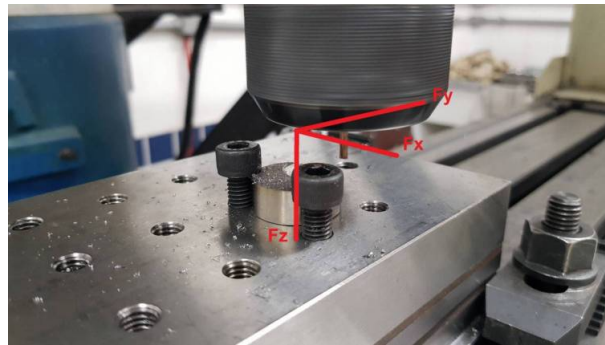
Figura 4: Direções de aquisição dos sinais de força do dinamômetro.
