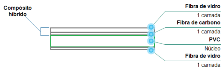
Figura 6. Configuração do compósito aeronáutico estrutural da empresa Stratus. Fonte – Autoria própria.
