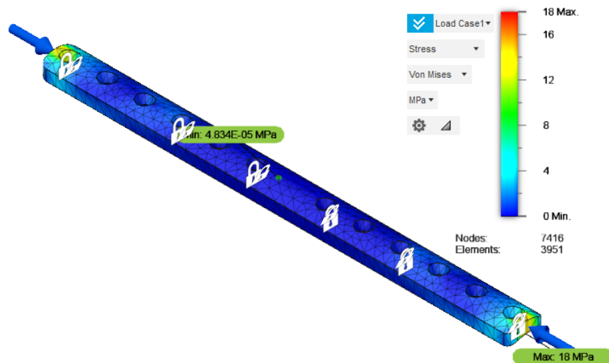
Figura 4: Resultado da distribuição da tensão de Von Mises para a geometria inicial da placa óssea.
