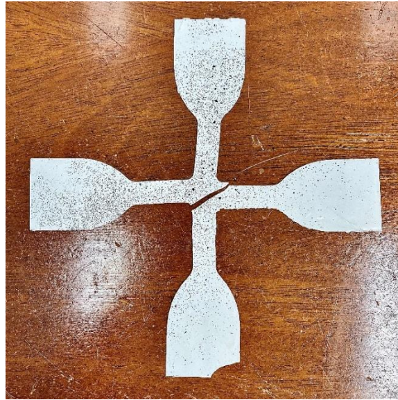
Figura 11: Corpo de prova após o ensaio equibiaxial (1:1).
