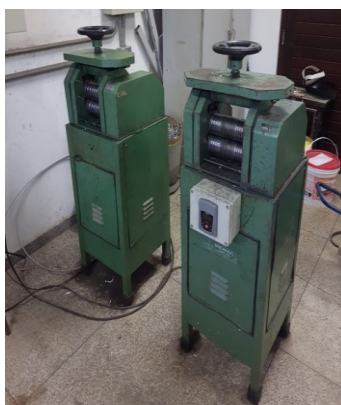
Figura 3. Laminadores utilizados na deformação plástica a frio do material. Fonte: GPEMAT, 2022.
