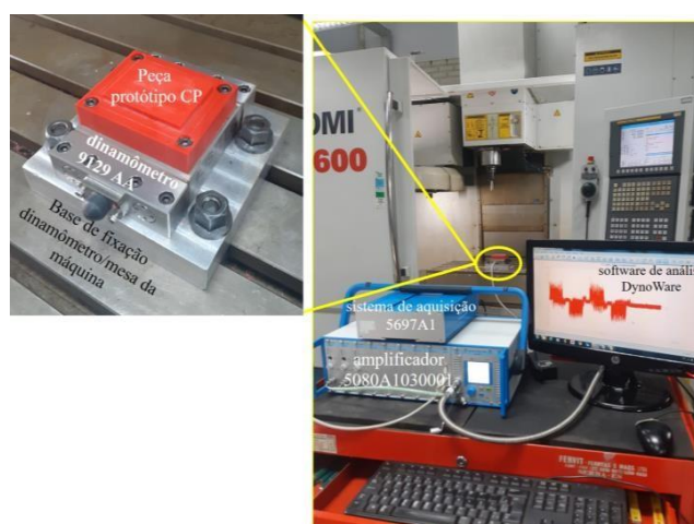
Figura 4. Sistema de medição de força de usinagem Kistler.
