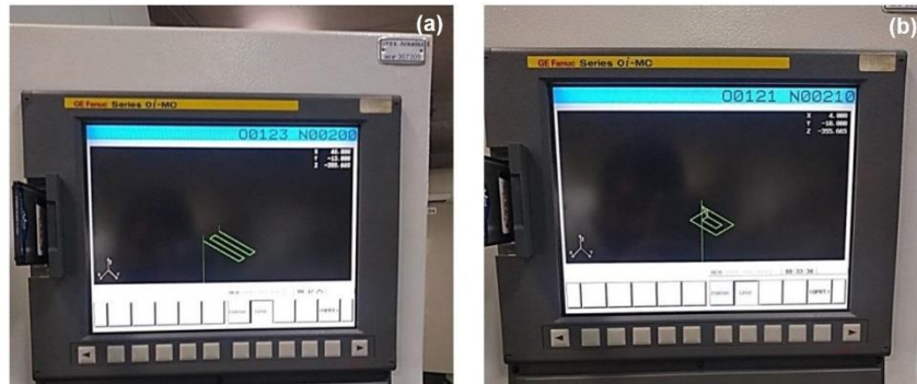
Figura 6. Teste gráfico no Centro de Usinagem CNC D600 para as trajetórias (a) longitudinal e (b) off-set .
