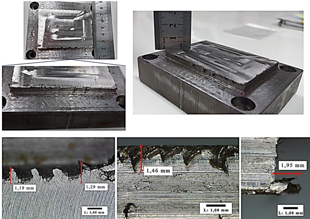
Figura 11. Caracterização visual e por microscopia óptica das rebarbas formadas na superfície de Inconel 625 pelo fresamento frontal de faceamento com a estratégia off-set .
