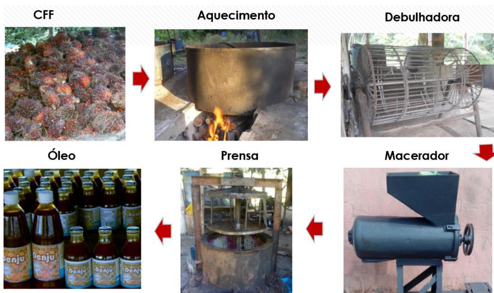
Figura 4. Ilustrações de equipamentos do fluxograma de processamento básico via macerador.
