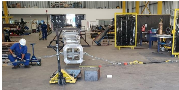
Figura 7. Execução do teste de Tração.
