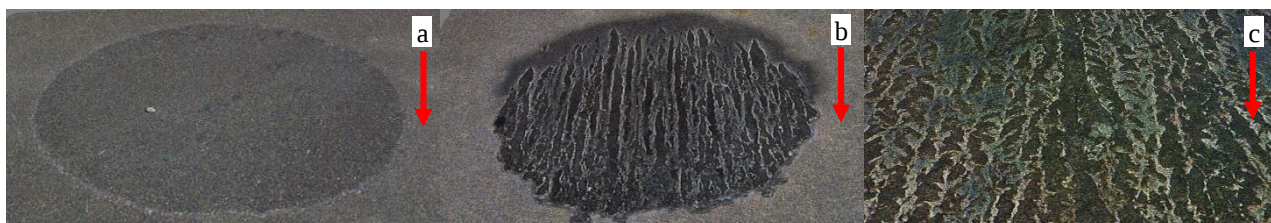
Figura 6. Morfologia do desgaste. (a) desgaste moderado, (b e c) desgaste severo. As setas indicam o sentido de deslizamento da esfera.
