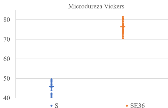
Figura 3. Gráfico apresentando a Microdureza Vickers das amostras. Os círculos representam cada uma das medições e o traço representa a média das medições.
