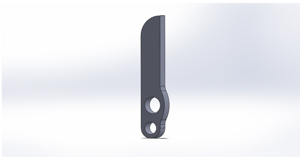
Figura 8. Modelo em CAD do pedal de freio do veículo fórmula SAE.
