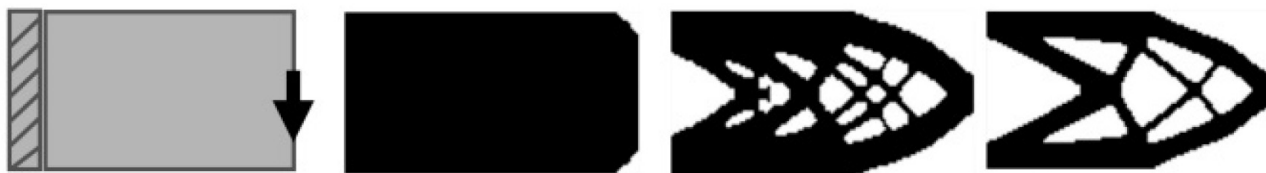
Figura 2. Método de otimização topológica com o domínio do projeto e as condições de contorno, com vários resultados de iterações mostrados ( Jankovics, 2019).
