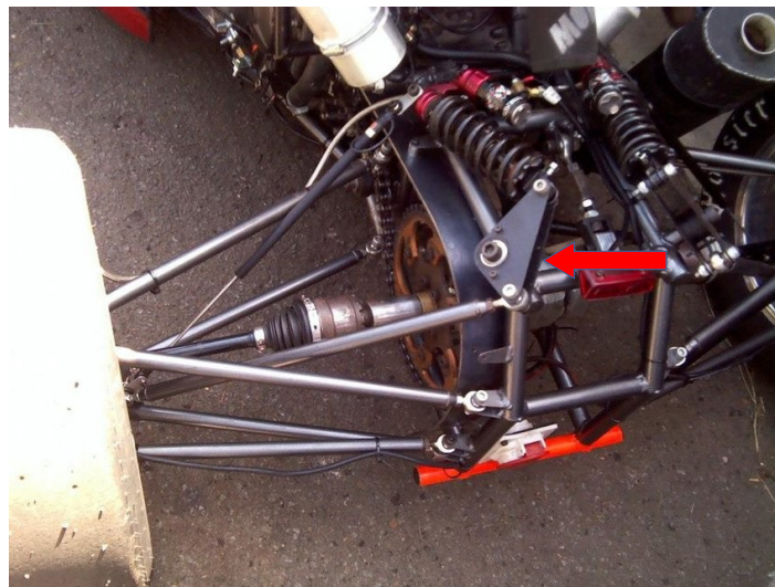
Figura 3. Vista do balancim na suspensão de um veículo Fórmula SAE (Rubio, 2017)
