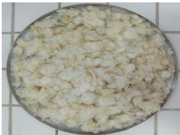
Figura 3. Escamas de peixes (100% EP): a) após secagem e b) após moagem e peneiramento. Fonte: Os autores (2022).
