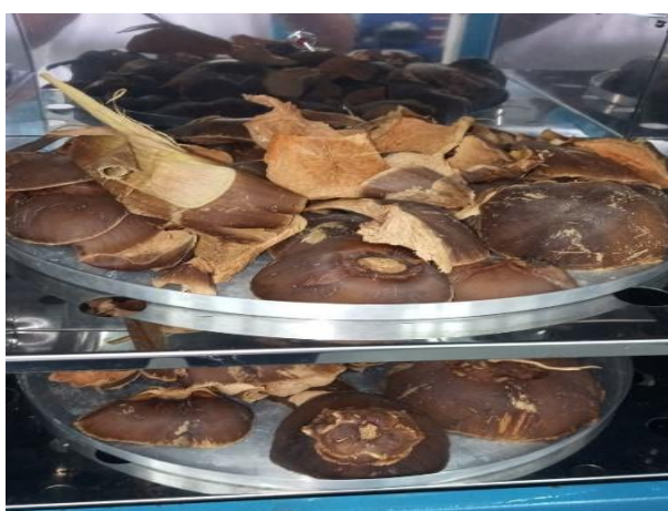
Figura 1. Cascas de coco verde secas em uma estufa por 48 horas a 60 °C. Fonte: Os autores (2022).
