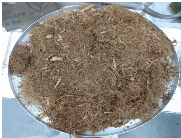
Figura 2. Fibras das cascas de coco verde após o processo de moagem em uma forrageira. Fonte: Os autores (2022).
