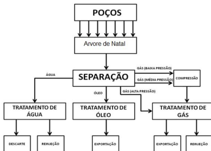
Figura 6. Esquema simplificado de uma planta de processamento de uma UEP (Paiva, 2017).
