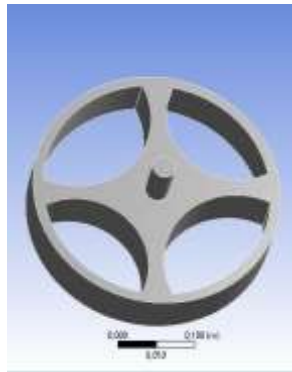
Figura 7. Análise modal do ADVPM model 2 com parâmetros aleatorizados.
