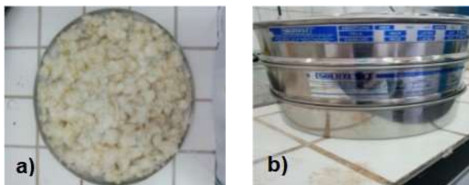
Figura 1. Etapas de tratamento - escamas de peixes: (a) secagem e (b) peneiramento. Fonte: Os autores (2021).
