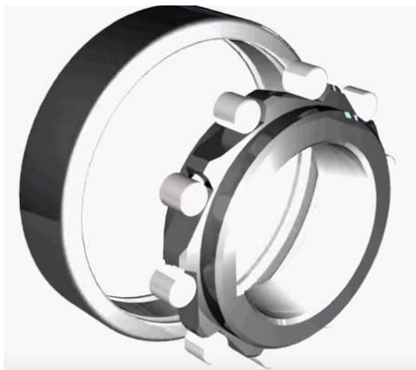
Figura 2. Partes do rolamento anti-retorno (fonte: Vídeo TecTor no Youtube, Abril 2018)
