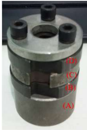
Figura 3. Freio de rolo de atrito. (fonte: autoria própria)
