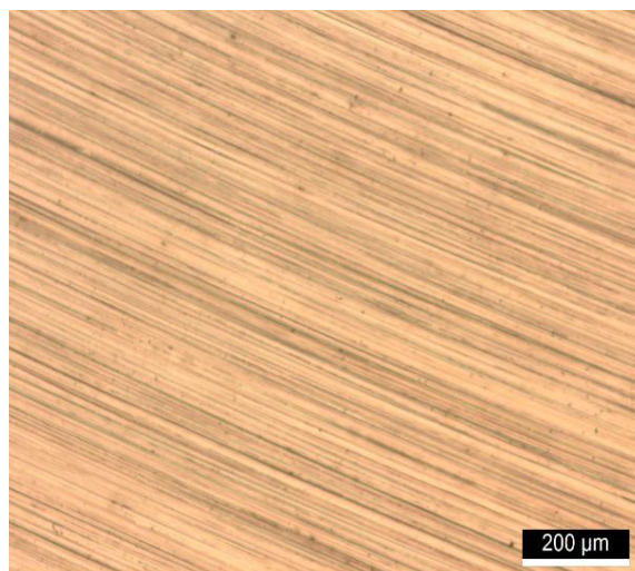
Figura 1. Microscopia óptica do corpo de prova antes da exposição ao meio corrosivo.
