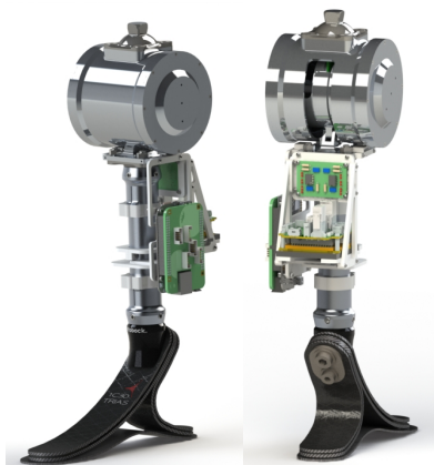
Figura 1. Protótipo digital da prótese ativa de joelho com eletrônica embarcada.
