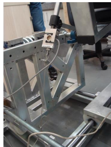
Figura 3 - Esquema de ligação da célula de carga para monitoramento da CIVM do voluntário (Fonte: o autor)
