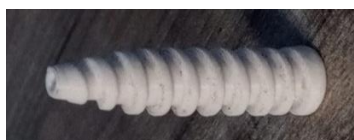
Figura 2. Parafuso de interferência impresso em PLA, autoria própria.
