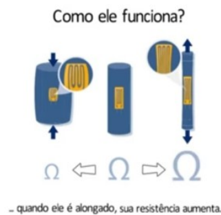
Figura 4. Funcionamento do extensômetro, HBM (2020)
