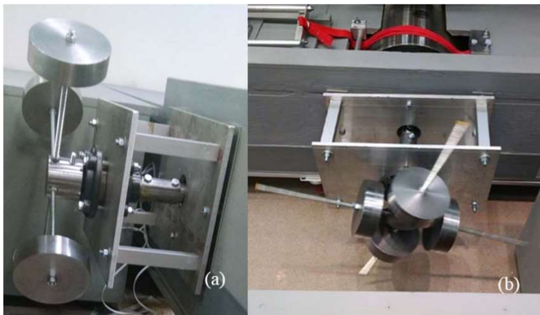
Figura 5. Sistema de inércia para propulsão em linha reta e sistema de resistência ao rolamento, Salimi e Ferguson-Pell (2018).
