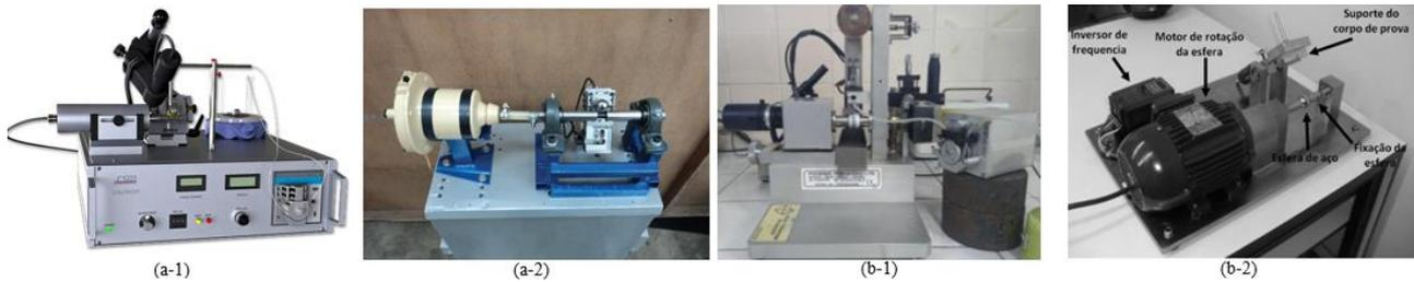
Figura 2. Equipamentos de micro-abrasão por esfera rotativa livre (a) e fixa (b), comerciais (1) e não comerciais (2).
