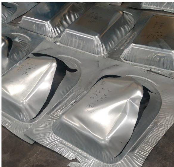
Figura 1. Caçambas conformadas após a realização do processo de estampagem
