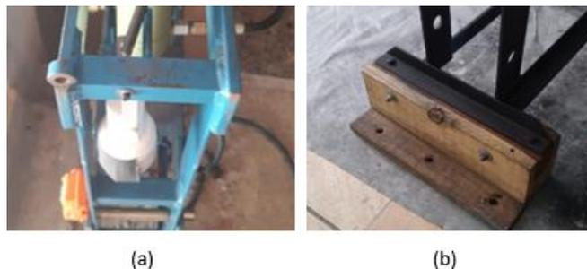
Figura 3.2 – Desgaste na pintura: (a) - Desgaste na pintura da estrutura aço SAE 1020 e (b) Desgaste no suporte de madeira da prensa hidráulica. (2021)
