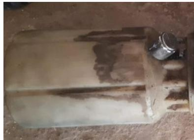
Figura 3.1 - Vazamento no reservatório. Acervo próprio (2021)
