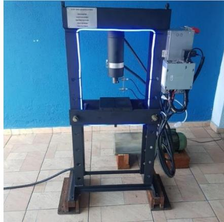
Figura 4 - Resultado do retrofit na prensa. (2021)
