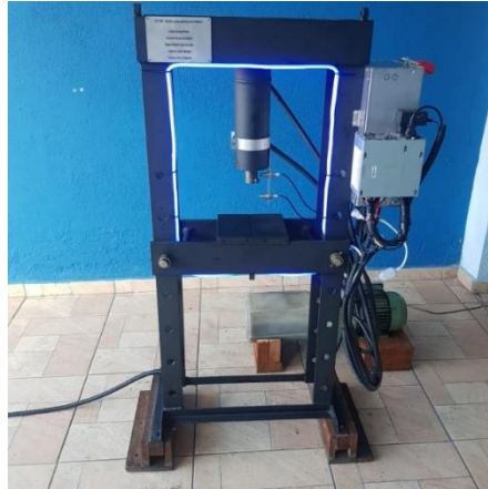
Figura 4 - Resultado do retrofit na prensa. (2021)
