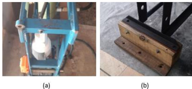
Figura 3.2 – Desgaste na pintura: (a) - Desgaste na pintura da estrutura aço SAE 1020 e (b) Desgaste no suporte de madeira da prensa hidráulica. (2021)
