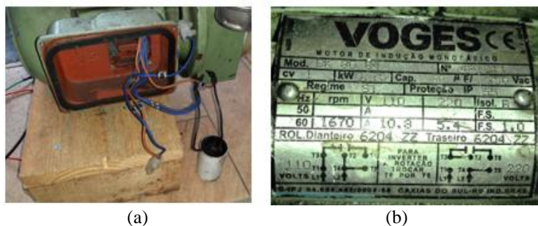
Figura 3.2 - fechamento do motor: (a) fotografia do fechamento do motor e (b) placa de especificação do motor.
